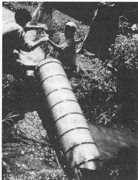
② アルキメデスのスクリュー、タンブール。筒を回転させて運河の水を農地の給水路に送る。下エジプト。
